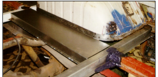
Abb. 17: Radkasten rechts (Original Radkasten angepaßt)
