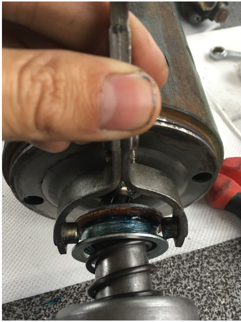
Die Ausrückführung am Freilauf wird leicht geschmiert, genauso wie die Welle und die Lagerbuchse auf der Vorderseite
