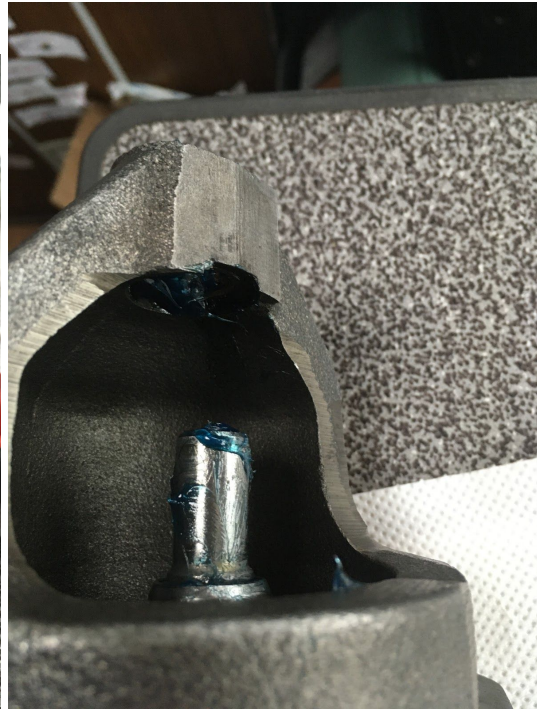
Die Ausrückführung am Freilauf wird leicht geschmiert, genauso wie die Welle und die Lagerbuchse auf der Vorderseite
