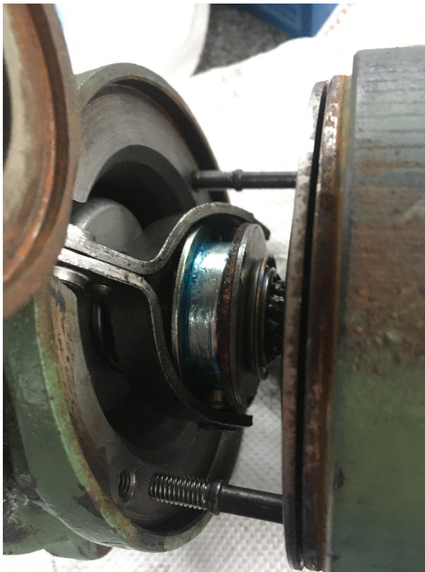
Die Ausrückführung am Freilauf wird leicht geschmiert, genauso wie die Welle und die Lagerbuchse auf der Vorderseite
