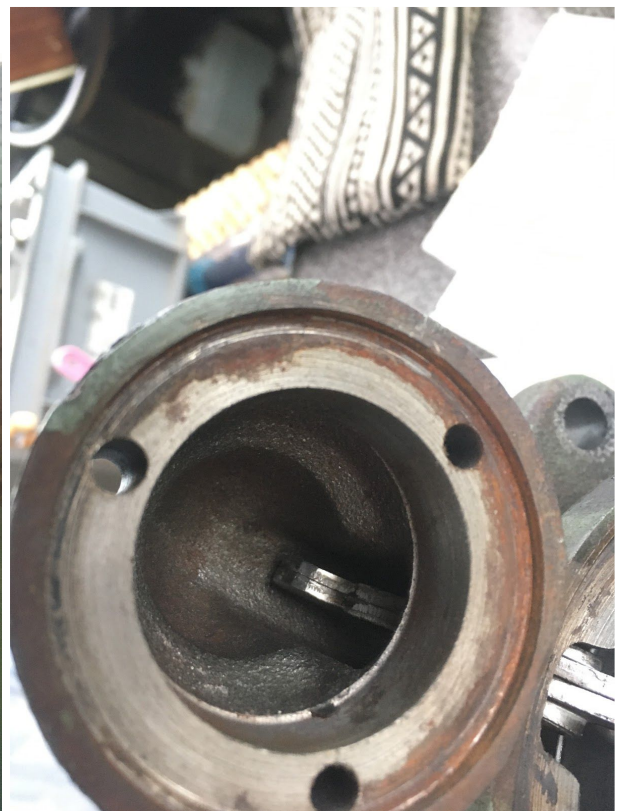
Die Ausrückführung am Freilauf wird leicht geschmiert, genauso wie die Welle und die Lagerbuchse auf der Vorderseite
